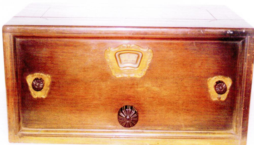
Fig. 51 Receptor de radio STEWARD – WARNER, uno de los primeros fabricados en Estados Unidos en los años veinte, con alimentación en c.a.
