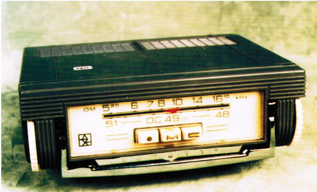
Fig. 57 Receptor de Radio convencional, con soporte para llevar en automóvil, con alimentación por pilas. Fabricado en Italia.
