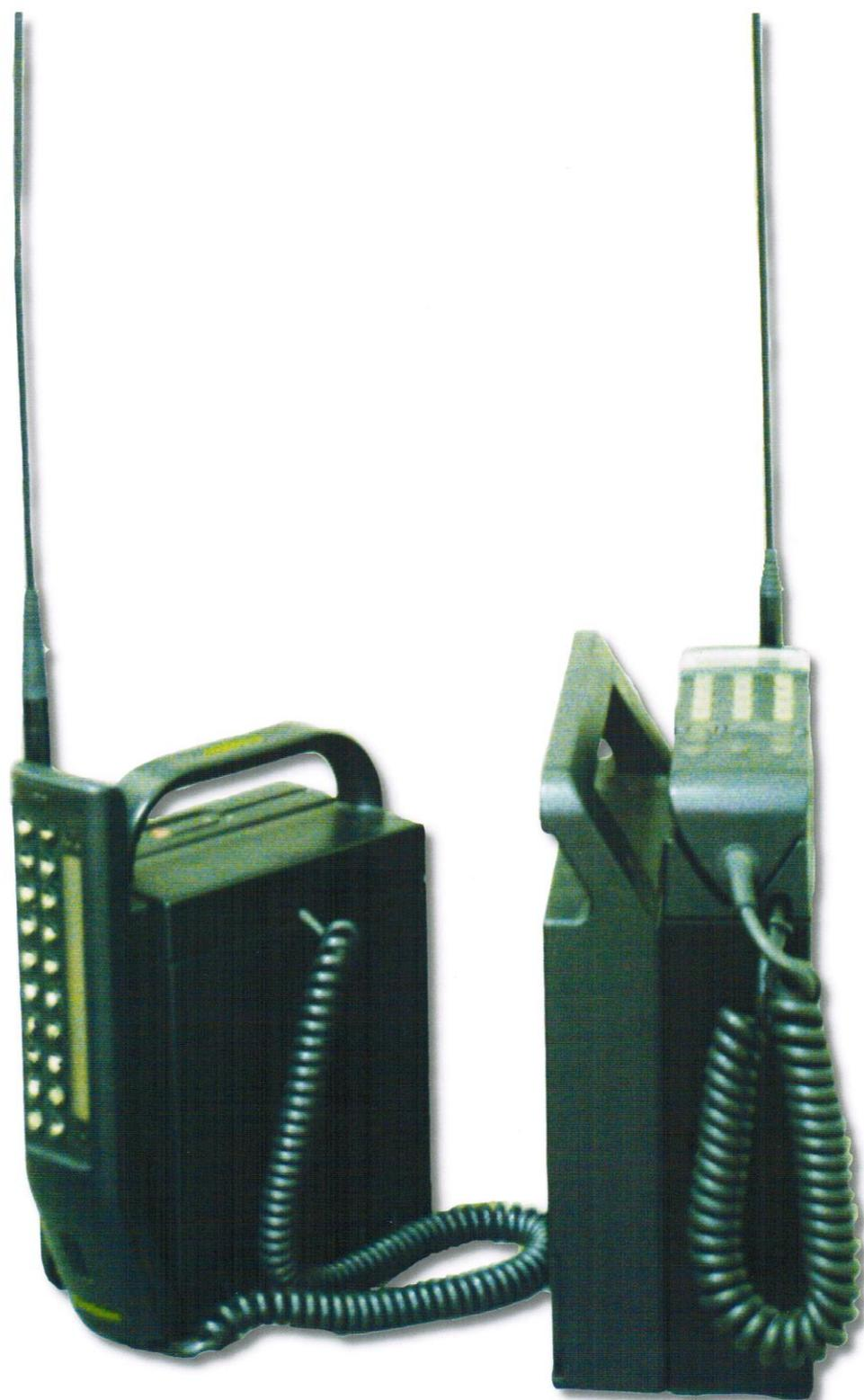
En la figura 95 se muestran dos equipos del primitivo sistema NMT, utilizados en España en 1982. Uno de ellos se fabricó en España por Indelec.
